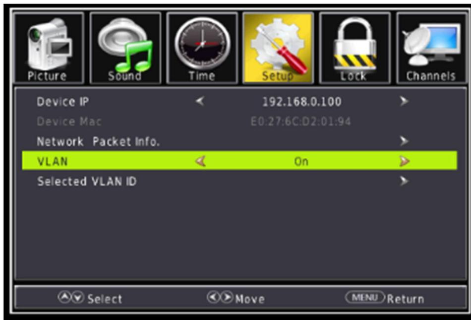
2. 選択した VLAN ID に移動します。Enter か ▶ を押して、VLAN ID 入力テーブルに移動します。
