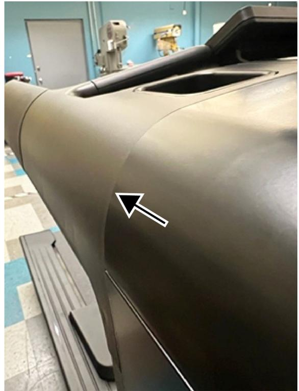
2. Sichern Sie die Abdeckung der linken oberen Brücke an der Brücke. Sichern Sie anschließend die Abdeckung der rechten oberen Brücke an der Brücke.
