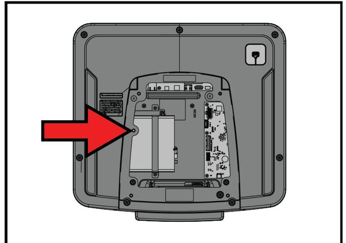
**NOTA:** No coloque el tornillo en la ubicación que se muestra (junto a la flecha) si la consola Discover SE4 tiene un receptor de sincronización con el decodificador (STB). El tornillo chocará contra el receptor del STB dentro de la consola.
